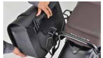
バタつき防止ベルトを外し、ロックを解除。ノブを握って持ち上げるだけで取り外し完了。
