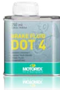
沸点が260℃(WET沸点165℃)と高い高性能プレミアムブレーキフルード。ペーパーロック現象に対する安全性に優れており、ABSシステムにも適しています。FMVSS 116 DOT 4 仕様に準拠したブレーキフルードを使用している車両の油圧ディスクブレーキなどに使用できます。同じ仕様のブレーキフルードであれば補充も可能ですが、本来の性能を発揮するためには、全交換することをおすすめします。米国自動車安全基準(FMVSS)No.116のDOT4、及びISO 4925 Class4に適合します。
