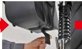
底面のバタつき防止ベルトを固定。
