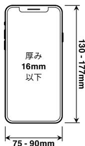
ボールジョイント機構により、自由度の高い位置調整が可能なスマートフォンホルダー。取り付けは、バネの力で元に戻る上部アームを引っ張り上げ、スマホを置くだけで簡単。8つのアームで大きいスマホもしっかり固定できます。振動吸収機構が、バイクの振動からスマホを守ります。別売のオプション品と組み合わせることで様々な箇所へ取り付け可能。対応スマートフォンサイズ:縦130~177×横75~90×厚み16(mm)以下、重量250gまで
